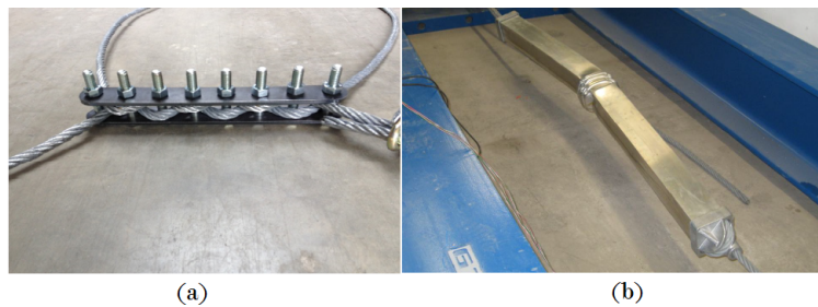
FIGURE 3.12 – Deux exemples de dissipateur : (a) frein serpent (source C2ROP), (b) dissipateur par flambement (source GTS)
