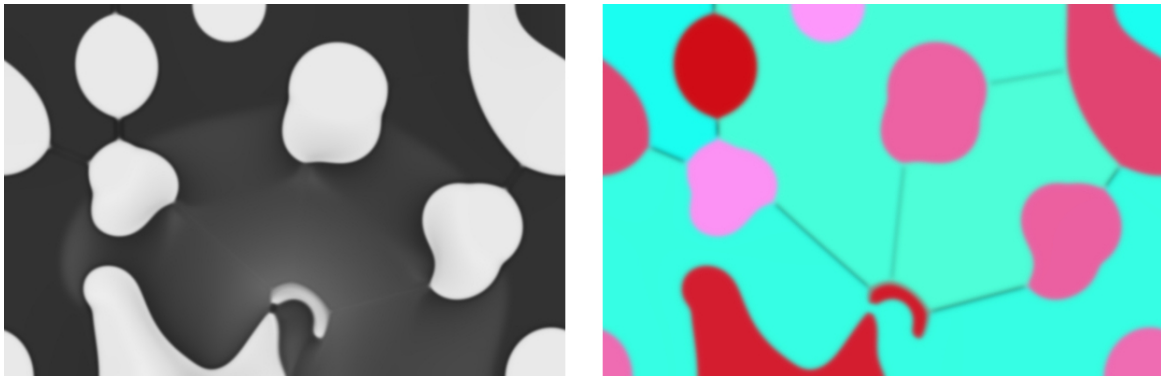
FIGURE 5.22 – État du système dont l'état initial est représenté sur la figure 5.18 lors de l'opération SET, 2.7 \mu\text{s} après le début de l'impulsion électrique d'écriture.
