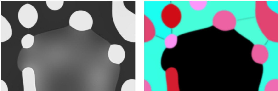
FIGURE 5.29 – État du système dont l'état initial est représenté sur la figure 5.28 lors de l'opération SET 100 ns après le début de l'impulsion électrique d'écriture.
