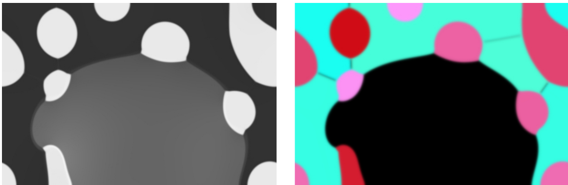
FIGURE 5.20 – État du système dont l'état initial est représenté sur la figure 5.18 lors de l'opération SET, 256 ns après le début de l'impulsion électrique d'écriture.
