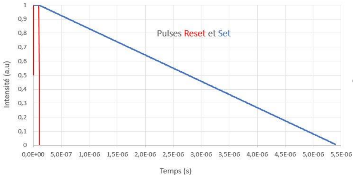
FIGURE 5.2 – Fonctions de courant en fonction du temps associées aux opérations SET (en bleu) et RESET (en rouge)
