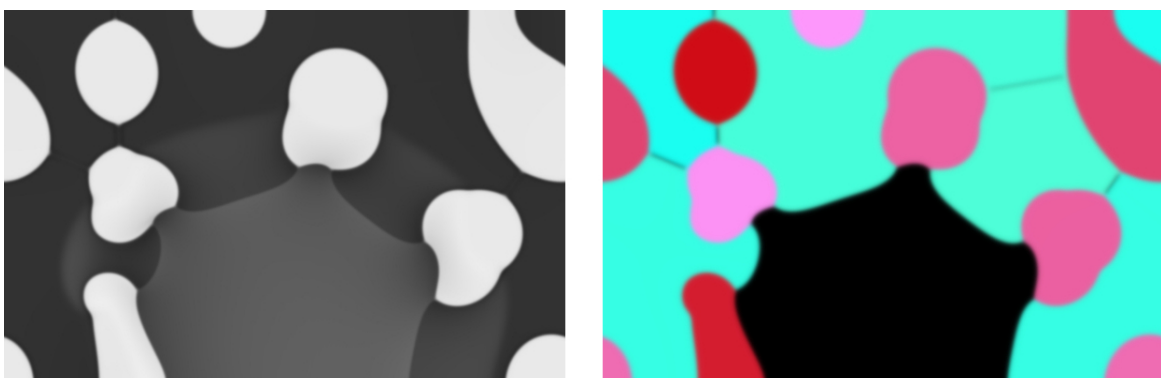
FIGURE 5.21 – État du système dont l'état initial est représenté sur la figure 5.18 lors de l'opération SET, 1.3 \mu s après le début de l'impulsion électrique d'écriture.
