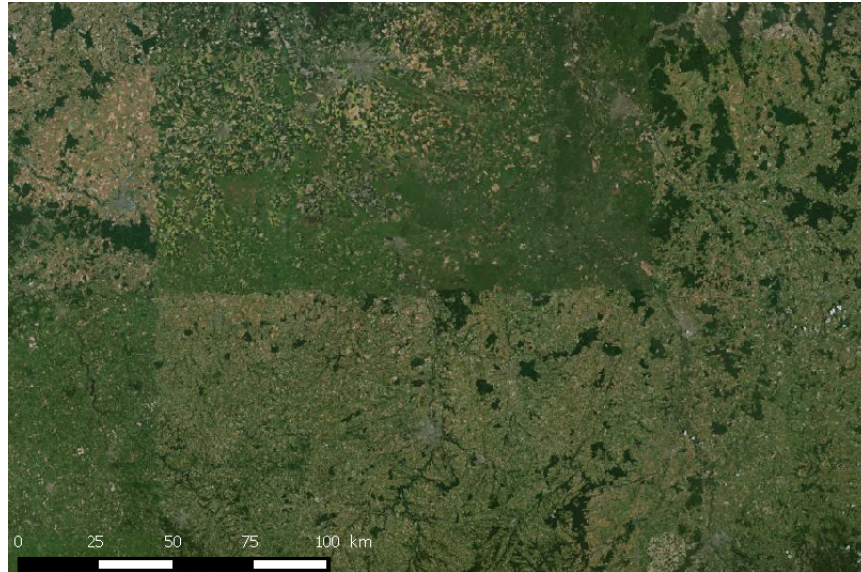
FIGURE III.1. Effet du phénomène de diachronie : les images d'une couverture étant acquises sur l'ensemble de l'année, deux régions voisines présentent des réflectance différentes pour une même classe.
