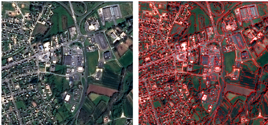
FIGURE III.21. A gauche : Image SPOT - A droite : segmentation utilisant la méthode (Felzenszwalb et Huttenlocher, 2004) avec k = 30 , m = 20 .
