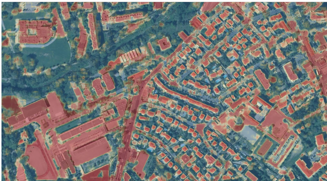
FIGURE IV.8. Détection du bâti sur Marseille avec le modèle appris sur la Vendée, sans MNS (non disponible).
