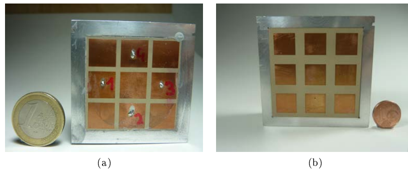
Figure 13: Prototypes manufacturés pour l'antenne de (a) petite ouverture de 40 \times 40 \text{ mm}^2 et (b) large ouverture de 50 \times 50 \text{ mm}^2
