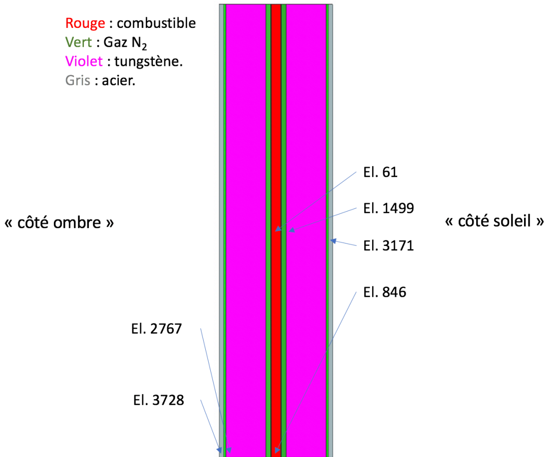
Figure 4.31. Endroits du calorimètre choisis pour montrer les évolutions en température.
