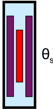
Figure 2.9. Calorimètre à fuites thermiques contrôlées.
