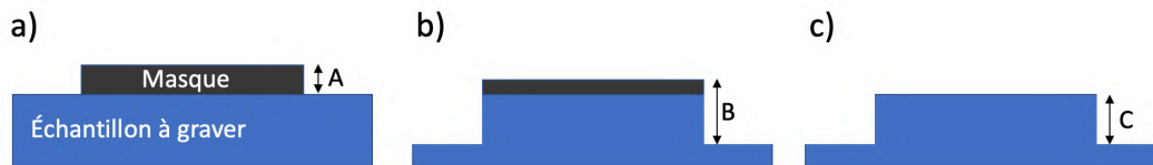
Figure 1.7 Schéma d'un échantillon à graver et de son masque a) avant gravure, b) après gravure, c) après enlèvement du masque
