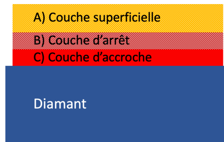
Figure I.11 Schéma de l'empilement de trois métaux constituant le contact métallique
