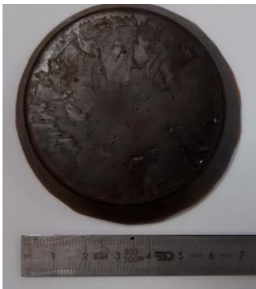
Figure 111. Résultats du moulage par compression moyenne pression de LS. (a) Condition 1 (cf. Tableau 70 ). (b) Condition 2 (cf. Tableau 70 ).
