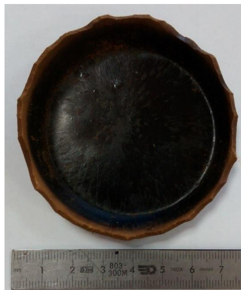
Figure 111. Résultats du moulage par compression moyenne pression de LS. (a) Condition 1 (cf. Tableau 70 ). (b) Condition 2 (cf. Tableau 70 ).
