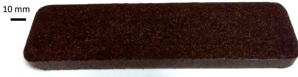
Figure 102. Agrocomposite à base de LS et rafle de maïs en présence de laccases, non-déformé par l'étape de séchage dans le cadre de l'expérience n°3.
