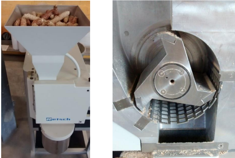
Figure 43. Broyeur à couteaux Retsch SM300 utilisé pour le broyage des rafles de maïs avec un tamis de 10 mm.
