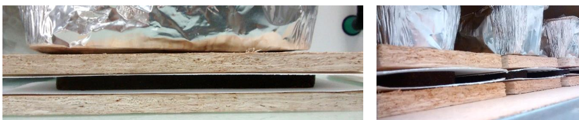
Figure 47. Protocole de séchage des agrocomposites LS/rafles de maïs et en présence de laccases dans l'expérience n°3.
