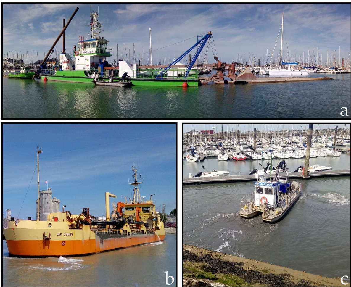
Figure I.6. Photographies des trois principaux navires permettant de lutter contre l'envasement dans le port des Minimes et son chenal de navigation. (a) La drague suceuse stationnaire « Avalis II » (b) La drague aspiratrice « Cap d'Aunis » (c) Le rotodévaseur « Mer d'Antioche ». (Source: Antoine Mérigot)
