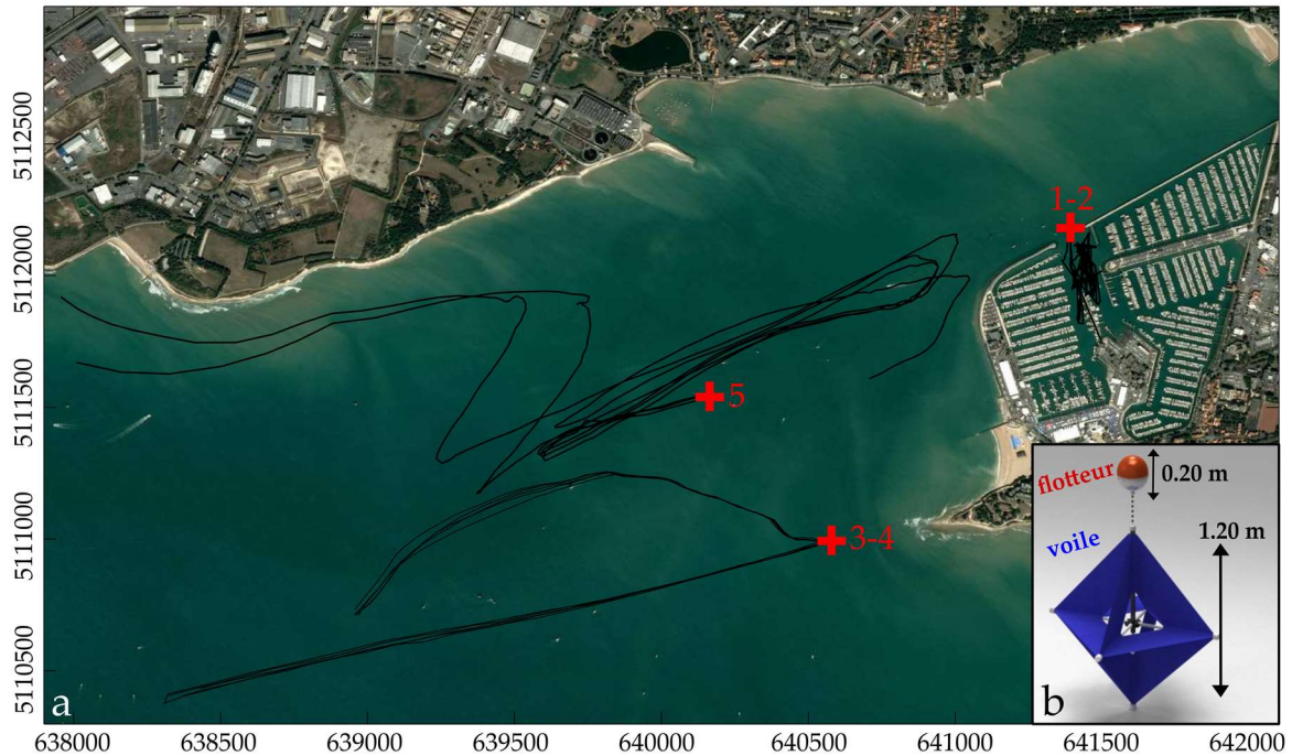
Figure III.4. (a) Vue d'ensemble (en Lambert 93) des trajets effectués (en noir) par les bouées dérivantes lors des 5 déploiements décrits dans le Tableau III.5. (b) Structure d'une bouée dérivante Pacific Gyre.
