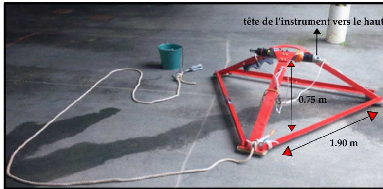
Figure III.3. L'ADCP Aquadopp Profiler 2 MHz et la structure tripode sur lequel il reposait pendant son acquisition. Collaboration effectuée avec le soutien technique de Thibault Coulombier (IE Université).
