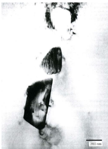
Figure 1.2. Image MET en champ clair de la microstructure des précipités Zr(Cr,Fe)_2 , d'après [1].
