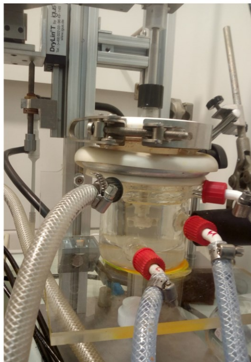
Figure 3-34. (a) Hélice utilisée pour agiter les croissances en régime de convection forcée dans les solutions aqueuses de HBr. (b) Montage expérimental.
