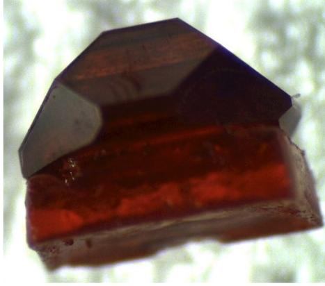
Figure 3-36. Image optique d'un monocrystal fait croître dans une solution aqueuse de HBr à 3,5 mol/L. La partie transparente du cristal, en bas, correspond au germe.
