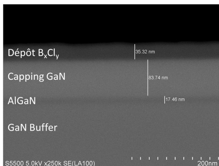
Figure 70 : Image MEB d'un échantillon GaN après 5 minutes de plasma BCl<sub>3</sub> à 10V.
