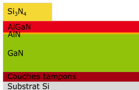
Figure 17 : Schéma des étapes de gravure utilisées durant la réalisation d'un transistor HEMT.
