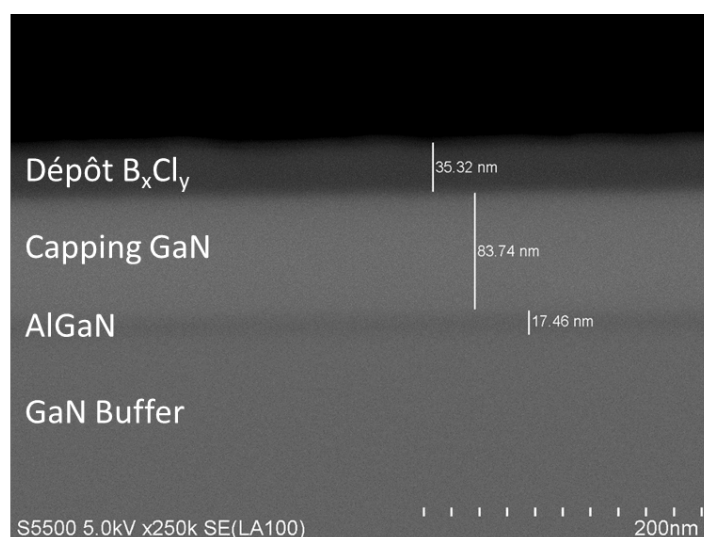
Figure 70 : Image MEB d'un échantillon GaN après 5 minutes de plasma BCl 3 à 10V.
