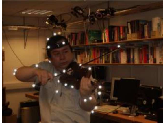
FIGURE 8 – Exemple de marqueurs réfléchissants positionnés sur une personne et un objet (Ng 2008).
