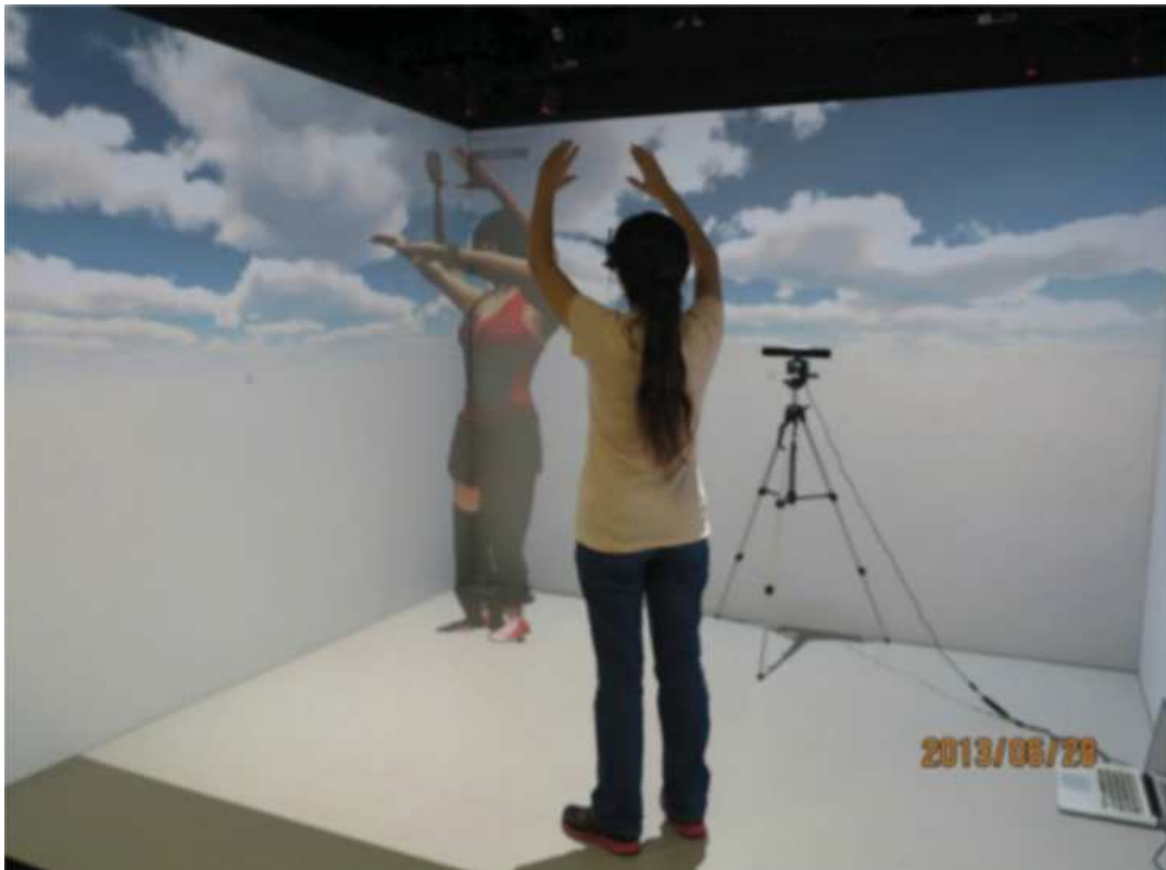
FIGURE 25 – Le système développé par Kyan et al. fait usage de la réalité virtuelle dans un système CAVE afin de proposer soit une observation côte à côte des mouvements de l'expert et de l'apprenant, soit superposée (cas de l'image) (KYAN et al. 2015).
