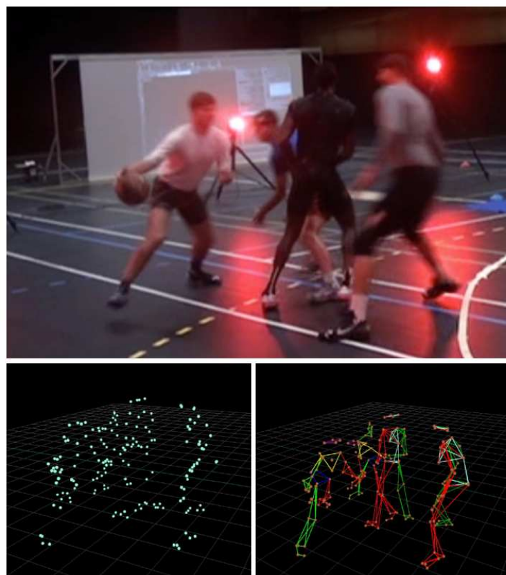
FIGURE 6 – Un système de captation à base de caméras infrarouges et de marqueurs disposés sur le corps (eu haut). Les données sont obtenues sont la forme d'un nuage de point (en bas à gauche), à partir desquels les squelettes sont reconstitués (en bas à droite) (MOREL 2017).
