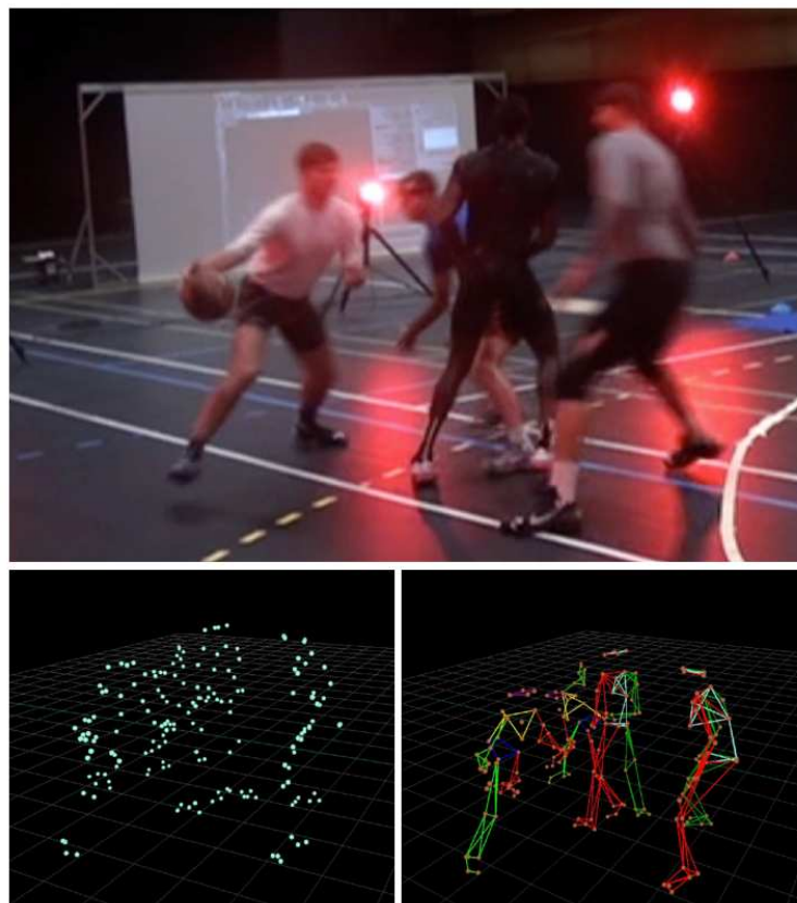
FIGURE 6 – Un système de captation à base de caméras infrarouges et de marqueurs disposés sur le corps (eu haut). Les données sont obtenues sont la forme d'un nuage de point (en bas à gauche), à partir desquels les squelettes sont reconstitués (en bas à droite) (MOREL 2017).
