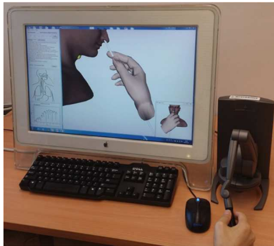
FIGURE 7 – Exemple de bras haptique servant à simuler l'insertion d'une sonde nasogastrique, avec un modèle 3D mis à jour en temps réel à côté (CHOI et al. 2015).
