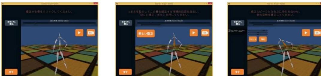
FIGURE 23 – L’environnement proposé par Yoshinaga *et al.* permet à l’expert de modifier directement les positions et les orientations des membres du corps de l’apprenant sur l’enregistrement du geste originel, afin de lui proposer des corrections à distance (YOSHINAGA et SOGA 2015).
