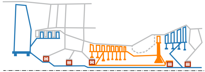
FIGURE I.9 – Coupe schématisée d'un turboréacteur double-corps possédant un palier inter-arbre. Rotor basse pression (—), rotor haute pression (—), paliers (—), stator (—).
