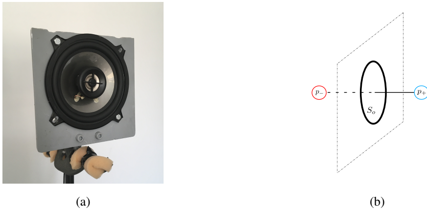
FIGURE 1.13 – (a) Photographie de la source dipolaire; (b) schéma du modèle du piston circulaire non-bafflé.
