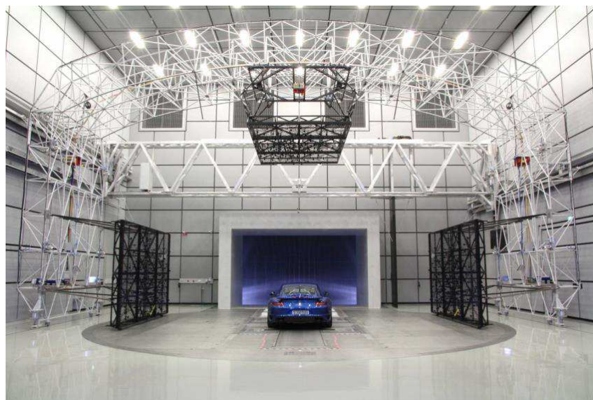
FIGURE 2.2 – Dans la soufflerie de l'entreprise Porsche, les trois structures de 192 microphones chacune peuvent se mouvoir autour d'une voiture soumise à un écoulement – Extrait de Döbler et al. [87].
