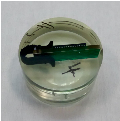
Figure B.1 Échantillon de boîtier BGA après polissage.
