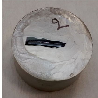
Figure 3.6 Échantillon de boîtier BGA préparé pour l'introduction au MEB.
