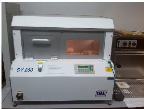
Figure 4.4 Four à phase vapeur IBL SV 260.
