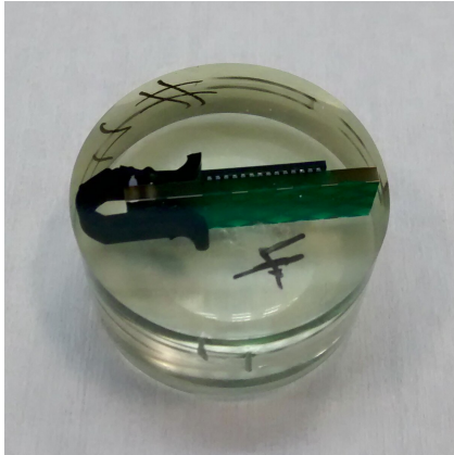
Figure 3.5 Échantillon de boîtier BGA après polissage.
