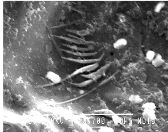
Figure 2.4 Image MEB de l'intérieur d'un void d'un joint de brasure SAC et qui montre des particules Ag_3Sn .
