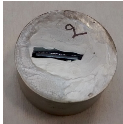
Figure B.2 Échantillon de boîtier BGA préparé pour l'introduction au MEB.
