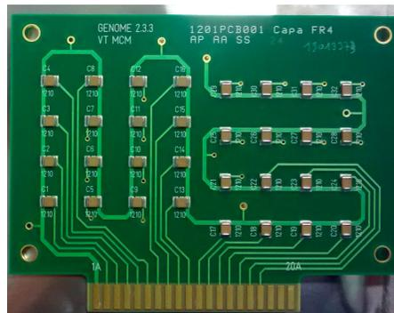
Figure 3.21 Carte de circuit imprimé avec des condensateurs céramiques.
