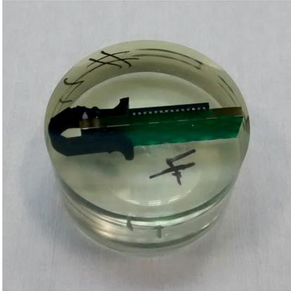
Figure 3.5 Échantillon de boîtier BGA après polissage.
