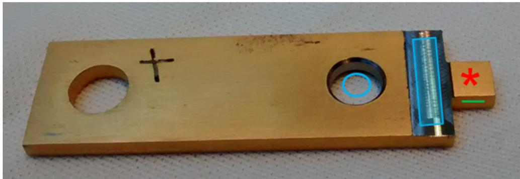
Figure 4.1 Barrette d'Invar après usinage.
