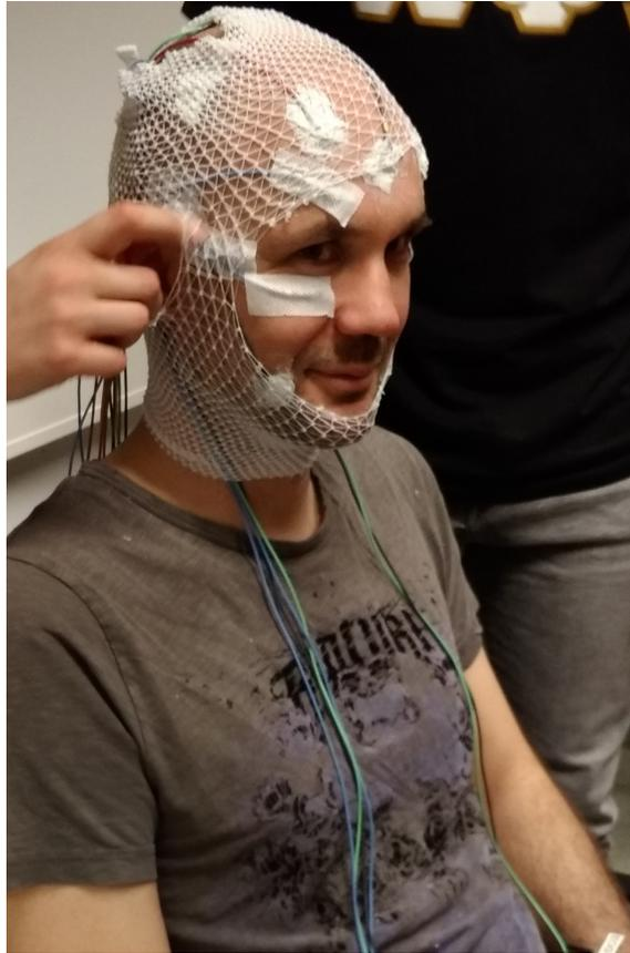
FIGURE 5.7 – Pose des électrodes mesurant l'EEG et l'EOG
