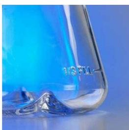
Figure 67: Flacon Fernbach, avec fond à ailettes
