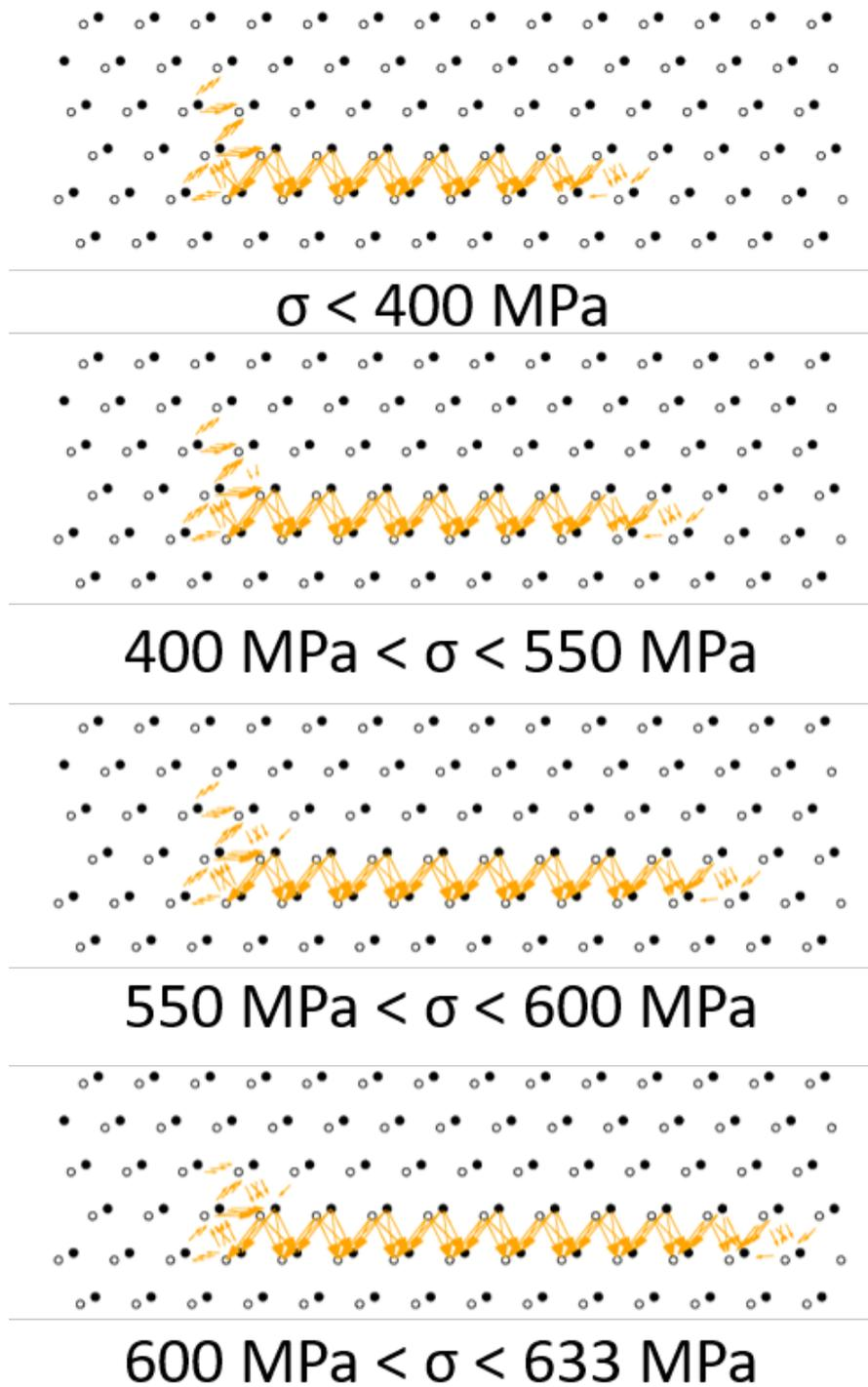
FIGURE 5.7 – Évolution de la structure de cœur de la dislocation vis  $\langle c + a \rangle$  en fonction de la contrainte appliquée. La direction de glissement est de la gauche vers la droite de l'image.
