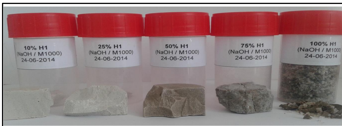
Figure 50: Exemple de matériaux obtenus en fonction du taux de substitution du métakaolin par le déchet H1.
