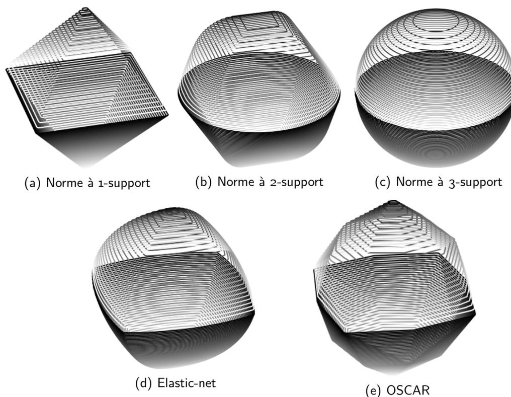
Figure D-2 : **Première ligne** : Boule unitaire de la norme à  $k$ -support en 3D pour les différentes valeurs de  $k$ . (a) présente la boule unitaire pour  $k=1$  – correspondant à la régularisation  $\ell_1$ , (b) présente la boule unitaire pour  $k=2$ , (c) présente la boule unitaire pour  $k=2$  – correspondant à la régularisation  $\ell_2$ . **Seconde ligne** : Régularisation Elastic-net – combinaison linéaire entre la norme  $\ell_1$  et  $\ell_2$  – et la boule unitaire d’OSCAR en 3D.
