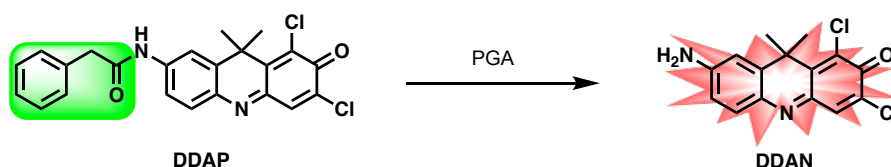
Figure 14. Structure et principe d'activation de la fluorescence rouge de la sonde DDAP , développée par les groupes de C. Wang et X. Ma, et permettant la détection de type "Off-On" de la PGA au sein de bactéries 56 .
