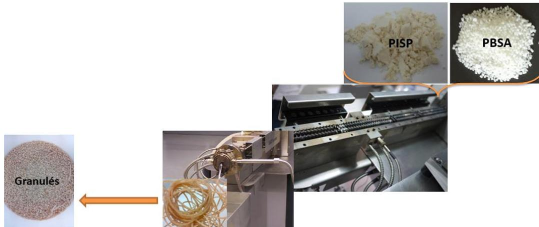
Figure II.3 : Illustration du procédé d'extrusion pour la fabrication des granulés des différents mélanges.
