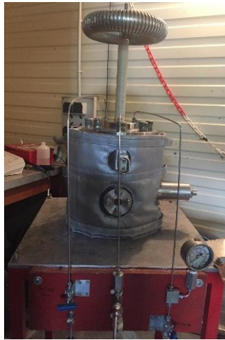
Figure 2-6 : Enceinte cylindrique pressurisée et réglée en température munie de sa traversée HT
