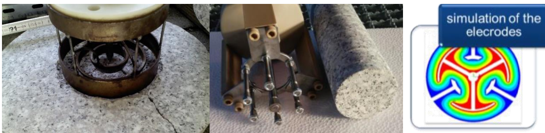
Figure 1-10 : Géométries d'électrodes coaxiales de TU Dresden et Freiberg [40], [42]
