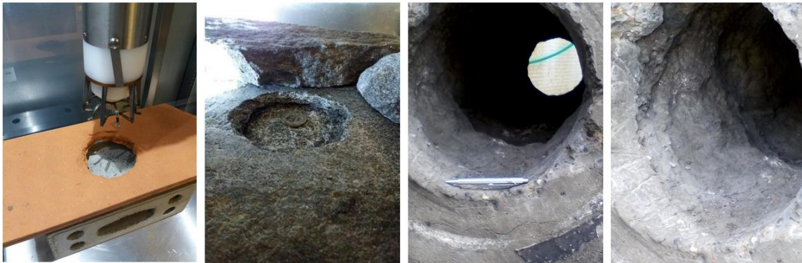
Figure 1-13 : Essais avec la technologie PPGD (diamètre 320 mm)
