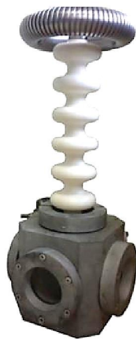
Figure 2-5 : Enceinte cubique non régulée et sa traversée HT
