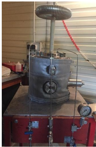
Figure 2-6 : Enceinte cylindrique pressurisée et régulée en température munie de sa traversée HT
