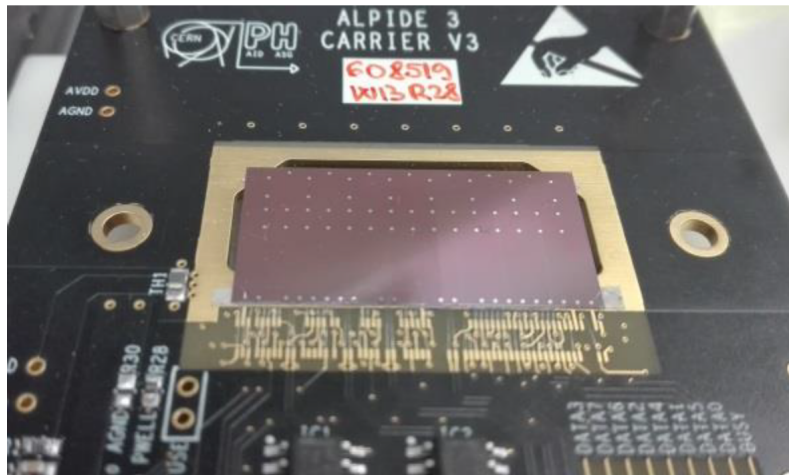
FIGURE 4.5 – Photographie d'un capteur ALPIDE sur un circuit imprimé. Image extraite de [151].
