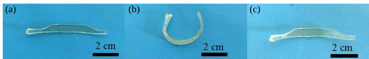
Figure IV- 5. Expérience de mémoire de forme pour le matériau hybride 1VA : 0,44Ti en présence de 40 % d'acétates de vinyle (a) forme permanente (b) forme temporaire stable obtenue sous contrainte en chauffant (c) forme recouvrée en chauffant sans contrainte
