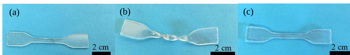
Figure IV- 1. Expérience de mémoire de forme pour le matériau témoin EVA-DCP (a) forme permanente (b) forme temporaire stable obtenue sous contrainte en chauffant (c) forme recouverte en chauffant sans contrainte
