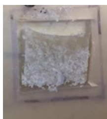
Figure IV- 46. Recyclabilité de l'hybride 1VA : 0,5Si sous presse à compression à 130 °C à 100 bar pendant 15 minutes à partir de poudres
