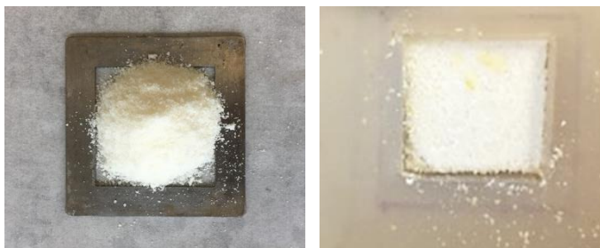
Figure IV- 45. Recyclabilité de l'hybride 1VA : 2,2Ti sous presse à compression à 130 °C à 100 bar pendant 15 minutes à partir de poudres
