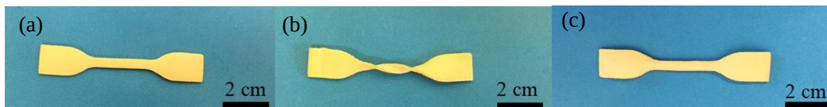
Figure IV- 6. Expérience de mémoire de forme pour le matériau hybride 1VA : 2,2Ti en présence de 24 % de fonction acétate de vinyle (a) forme permanente (b) forme temporaire stable obtenue sous contrainte en chauffant (c) forme recouvrée en chauffant sans contrainte
