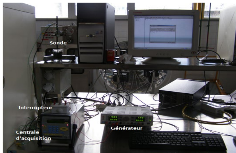
Figure II.13: Dispositif expérimental de mesure de la conductivité par la méthode du fil chaud.
