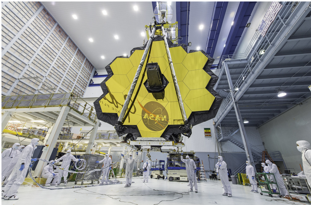
FIGURE 2.6 – Photo du miroir primaire du JWST en position déployée lors de tests réalisés au centre spatial NASA Goddard. Crédits : NASA/Desiree Stover.
