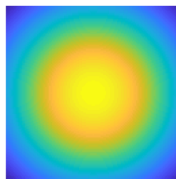
FIGURE 1.6 – Noyau de convolution : gain en sinus cardinal de largeur 1 dans l'espace des fréquences réduites. Le centre de l'image coïncide avec la fréquence (0,0).
