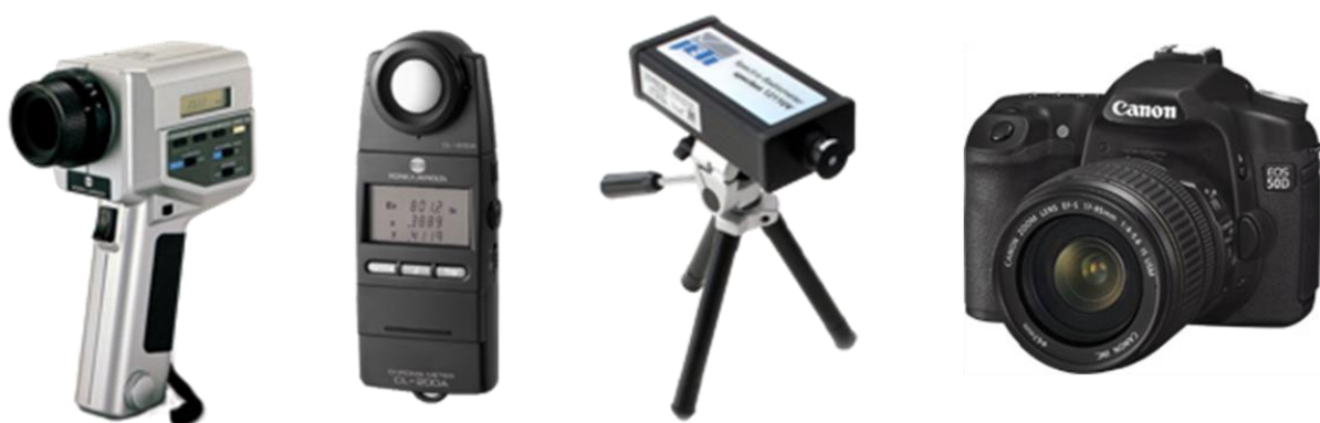
Figure 24 – Illustrations (de gauche à droite) du luminancemètre LS110, du chromamètre CL200, du spectro-radiomètre Specbos 1211-UV et de l'appareil photo EOS 50D (sources : sensing.konicaminolta.us ; scientec.fr ; canon.fr )
