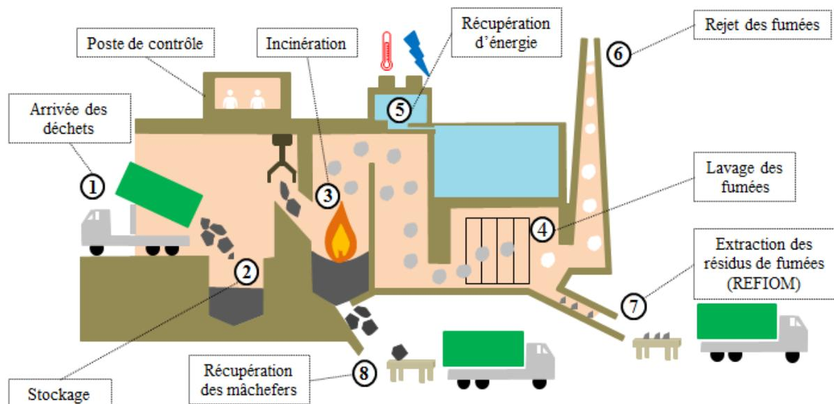
**Figure 7:** Descriptif d'une usine d'incinération des déchets ménagers
