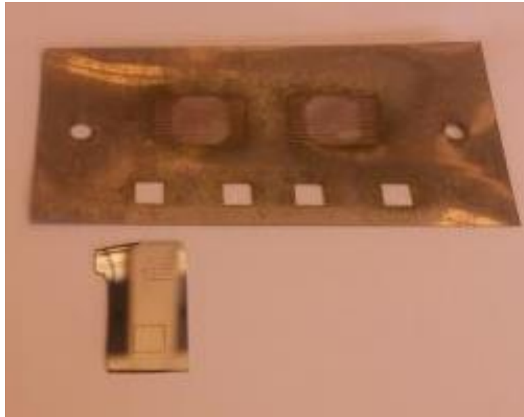
Figure 30. Photo du masque et du substrat ayant servi au dépôt de Co/N/NTC par pipette pour une surface contrôlée (lignes et carré).
