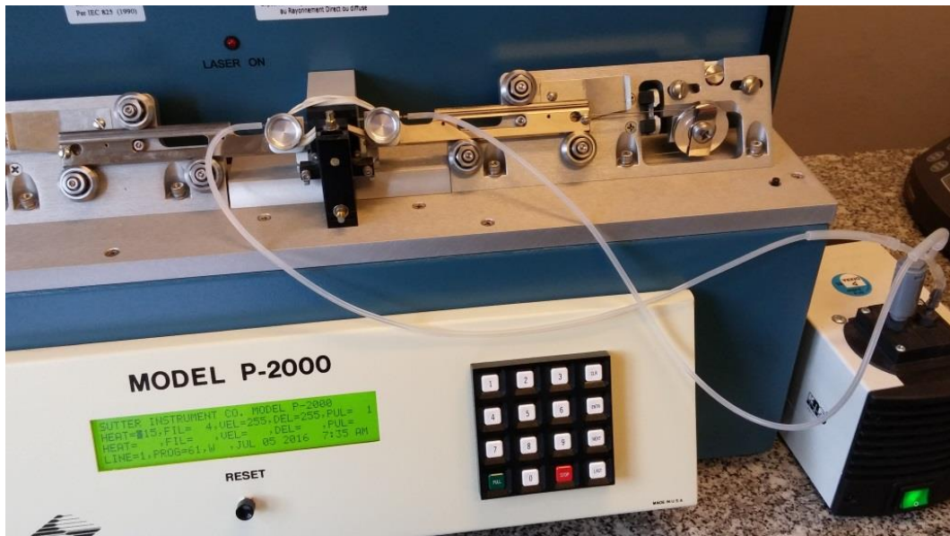
Figure 15. Montage permettant de sceller le fil d'or.
