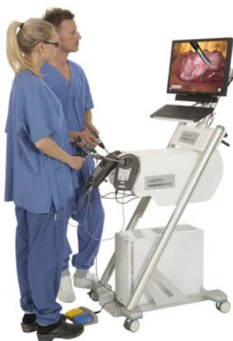
Figure 1-2 – Simulateur haptique pour la laparoscopie : Lapsim (SurgicalScience)
