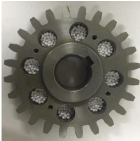
Figure 28 : Roue remplie par un matériau granulaire [Xia20162]
