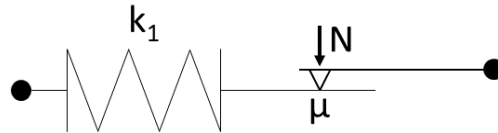
Figure 36 : Modèle à paramètres concentrés 1D : de Jenkins
