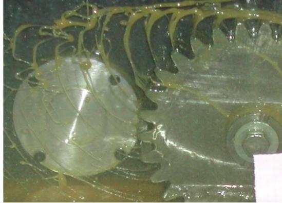
Figure III.12 – Photo illustrant le phénomène de projection d'une roue, tirée de Changenet [16]
