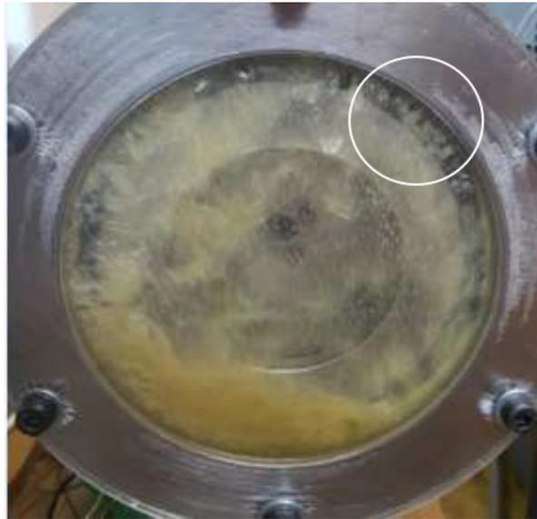
Figure II.9 – Flux d’huile quand les satellites sont montés. Le piégeage est montré par un cercle blanc
