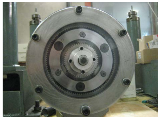
(d) Réducteur complet avec plaque de polycarbonate incolore
