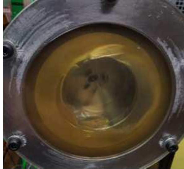
Figure II.8 – Flux d’huile autour du porte-satellite. L’anneau d’huile est créé en périphérie à cause des effets centrifuges
