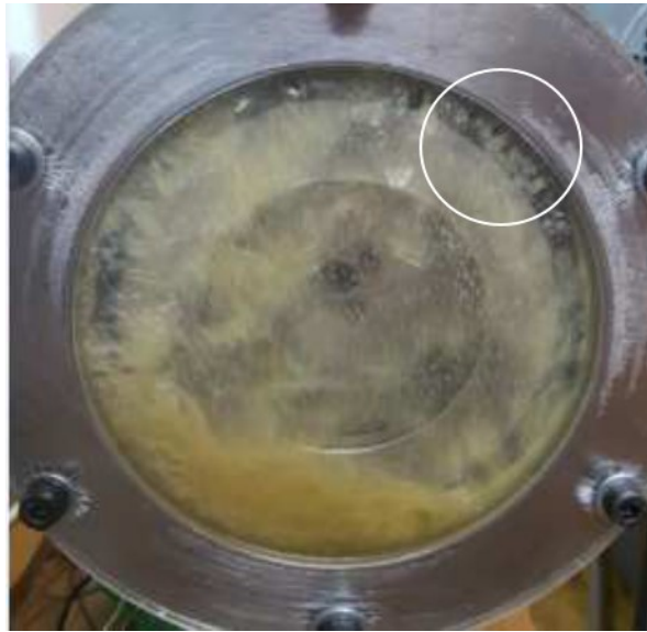
Figure II.9 – Flux d’huile quand les satellites sont montés. Le piégeage est montré par un cercle blanc
