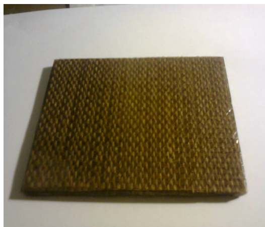
Figure II.2. Exemple d'une plaque composite fabriqué par moulage au contact.
