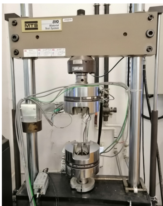
Figure II.9. Machine hydraulique MTS 810 utilisée pour faire les essais.
