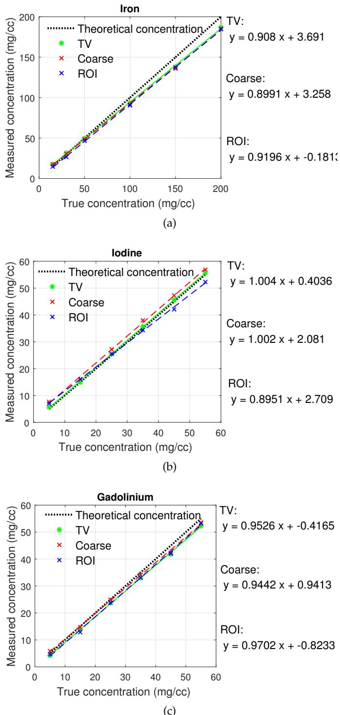
Figure 12: Les régressions linéaires de la décomposition de matériaux en utilisant trois méthodes pour (a) le fer, (b) l'iode et (c) le gadolinium.
