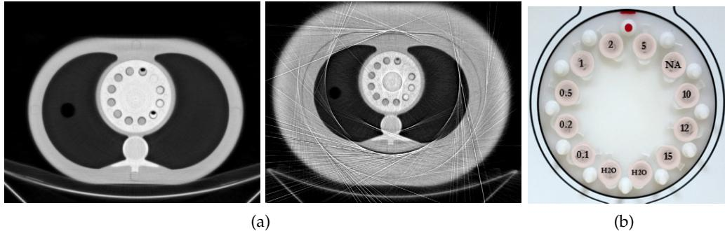
Figure 19: (a) Fantômes physiques sans (gauche) et avec (droite) gros anneau: gadolinium au 4ème bande; (b) inserts: les étiquettes font référence à la concentration nominale présente dans chaque tube (mg/cc).
