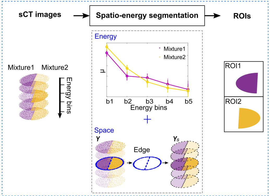
Figure 10: Diagramme de la segmentation spatio-énergétique. De gauche à droite: images spatiales multi-énergie contenant le mélange 1 et le mélange 2, la segmentation spatio-énergétique utilisant les caractéristiques spectrales (haut-moyen) et spatiales (bas-moyen), et les ROI segmentés.
