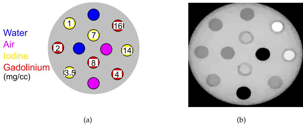
Figure 5: (a) Le fantôme physique; (b) l'image reconstruite du fantôme physique à la première borne d'énergie.
