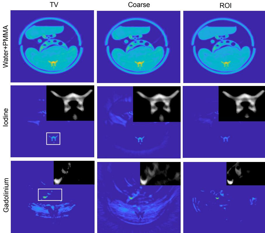
Figure 14: Les résultats de la décomposition de matériaux sur la base du fantôme physique. De gauche à droite: Pseudo-inverse avec TV, Coarse et ROI.
