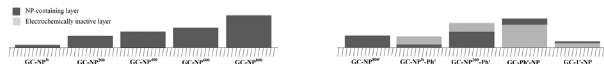
Schéma I-16 : Structure des différentes couches mixtes obtenues par greffages successifs du nitrobenzène diazonium et d'un second précurseur diazonium (repris de la référence 114).
