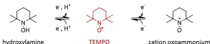
Schéma IV-1 : Forme réduite (hydroxylamine) et oxydée (ion oxoammonium), du TEMPO.
