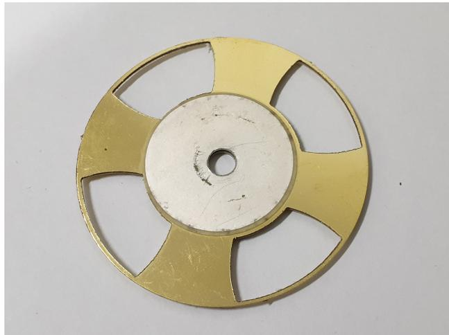
FIGURE 4.10 – Buzzer piézoélectrique découpé sous forme de croix pattée en utilisant la découpe à jet d'eau.
