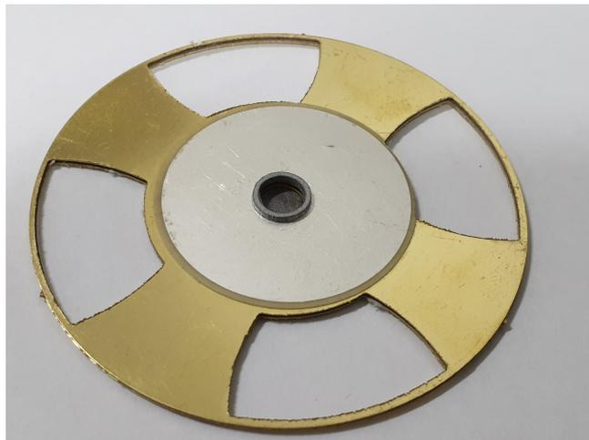
FIGURE 4.13 – Collage d’un anneau en aluminium de rayon interne de 3 mm et externe de 4 mm, sur la face inférieure de la poutre, à travers lequel l’ensemble est fixé sur un support rigide.
