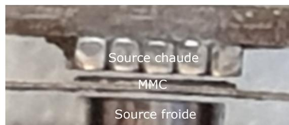
FIGURE 4.1 – Équilibre stable du MMC entre les deux sources chaude et froide
