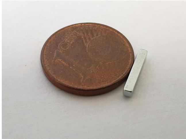
FIGURE 3.2 – Aimant NdFeB ( $1,5 \times 1,5 \times 10 \text{ mm}^3$ ). Les aimants NdFeB choisis présentent un revêtement de protection en Nickel (Ni-Cu-Ni) d’une épaisseur d’environ  $12 \mu\text{m}$ . [19]
