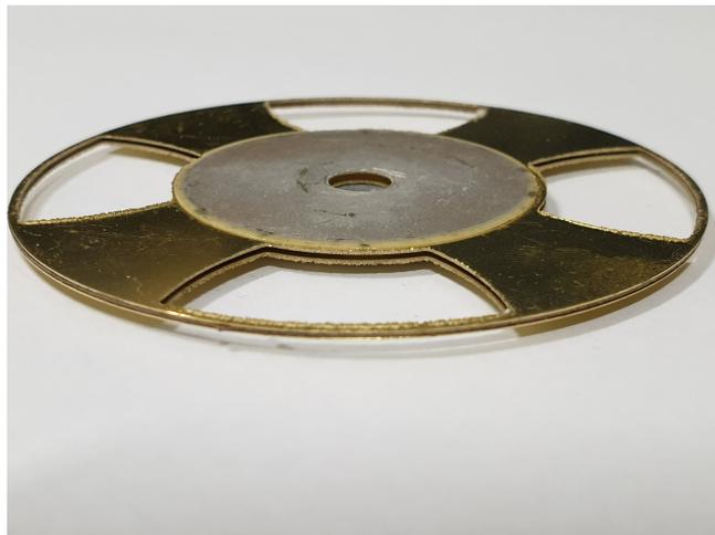
FIGURE 4.11 – Collage de deux buzzers piézoélectriques à travers un anneau en CuBe2 de diamètres interne de 63 mm et externe de 65 mm.
