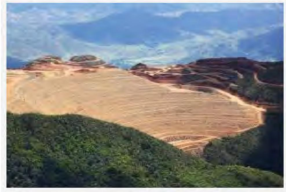
FIGURE 1.13 – Extraction sur gradin
