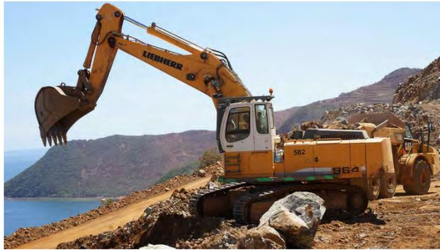
FIGURE 1.11 – Le décapage avant l'extraction
