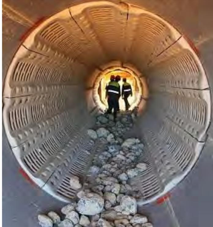
FIGURE 1.14 – Le trommel, engin minier de tri
