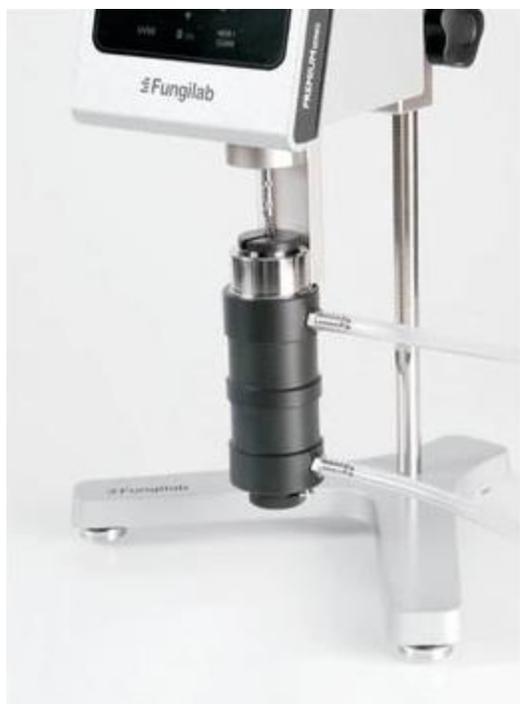
Figure II - 13 : Viscosimètre Fungilab utilisé
