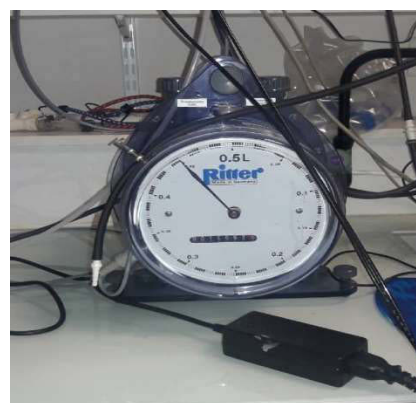
Figure 2:10. Chaîne micro-GC (à gauche) et compteur volumétrique (à droite) utilisés pour la mesure de la production et de la composition du biogaz.
