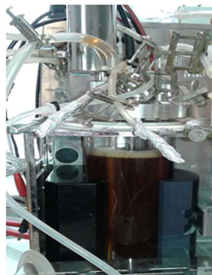
Figure 2:6. Réacteur de 500 mL utilisé pour la fermentation alcoolique en phase liquide.
