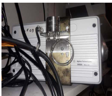
Figure 2:10. Chaîne micro-GC (à gauche) et compteur volumétrique (à droite) utilisés pour la mesure de la production et de la composition du biogaz.
