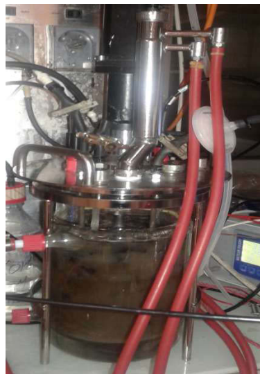
Figure 2:9. Réacteur utilisé pour la production d'hydrogène de deuxième génération à partir de déchet de caroube.
