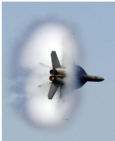
**Figure 1-17 :** Avion de chasse en vol transsonique (United States Navy ID 061105-N-8591H-389).
